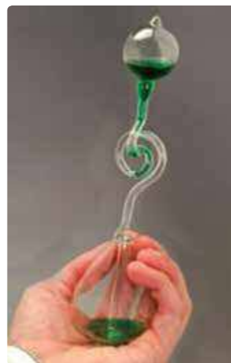
شکل ۴-۴۳ با در دست گرفتن حباب شیشه‌ای و گرم کردن آن، مایع رنگی در لوله مارپیچ بالا می‌رود.
