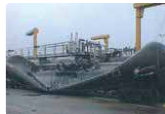
شکل ۴-۴۲ سرد شدن هوای درون مخزن باعث کاهش فشار این هوا و در نتیجه محاله شدن مخزن شده است.
