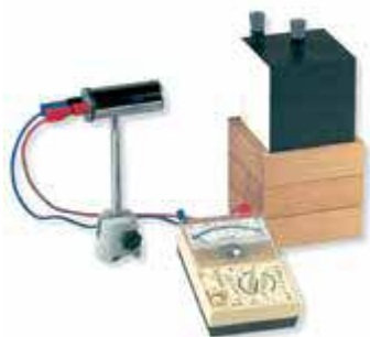
شکل ۴-۳۸ درون مکعب لسلی، آب داغ می‌ریزند. تابش گرمایی از چهار وجه مکعب، که رنگ‌های متفاوتی دارند، با هم فرق دارد.
