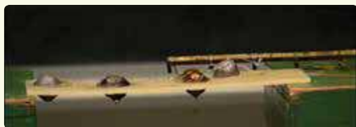
گوی ها بسته به جنس خود، ورقه پارافین را در زمان های متفاوت ذوب می کنند.
