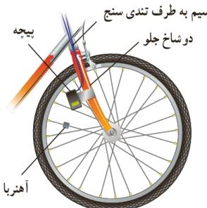
عبور آهنربا از جلوی پیچه متصل به دوشاخ جلوی دوچرخه، سبب تغییر شار مغناطیسی عبوری از پیچه و در نتیجه القای جریان می شود. این جریان توسط یک رایانه کوچک خوانده می شود و با توجه به تعداد مرتبه ای که این جریان القایی در یک زمان مشخص (مثلاً یک دقیقه) توسط رایانه ثبت می شود و همچنین با توجه به قطر چرخ که در رایانه وجود دارد، سرعت سنج دوچرخه کار می کند.
