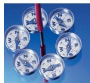
یک مقوا را از وسط حلقه‌دایره‌ای حامل جریان عبور می‌دهیم سپس تعدادی عقربه مغناطیسی مطابق شکل در اطراف حلقه قرار می‌دهیم، می‌بینیم جهت عقربه در داخل و خارج حلقه مخالف هم خواهد بود
