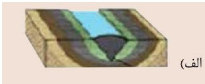
در این شکل حالت نامطلوب برای احداث سد دیده می شود به دلیل وجود گسل فرار آب وجود دارد و جهت محور سد با سطح لایه بندی موازی نیست و...
