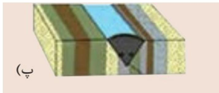
در این شکل حالت نامطلوب برای احداث سد دیده می شود به دلیل وجود گسل فرار آب وجود دارد و جهت محور سد با سطح لایه بندی موازی نیست و شبیه هم مناسب نیست.
