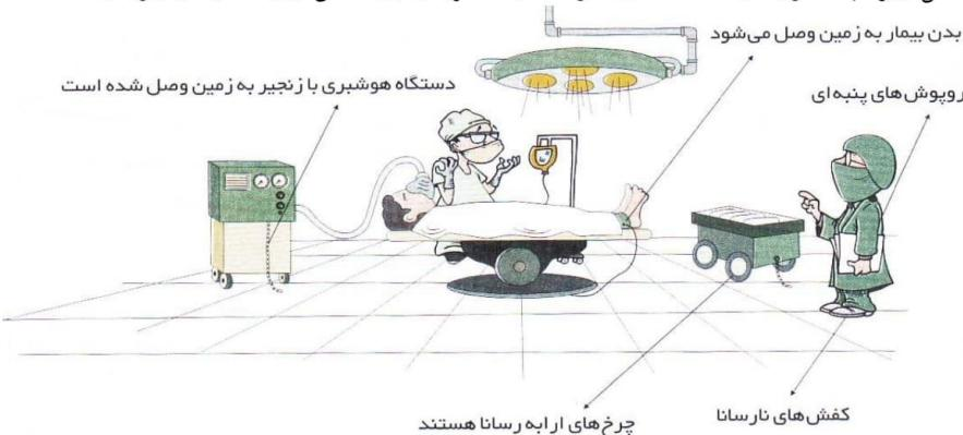
اجزایی که در آنها مالش یا حرکت وجود دارد باید به زمین وصل شوند تا به تدریج تخلیه شوند یا باید از جنسی باشند که در اثر مالش باردار نشوند. این اجزا عبارتند از: بدن و لباس بیمار، ارابه‌ی ابزار و زمین، اجزای دستگاه هوشبری و تنفس مصنوعی، کفش‌های متضدیان.
