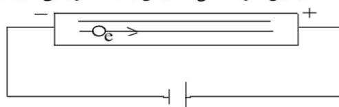
وقتی در رسانا میدان الکتریکی نباشد یعنی رسانا به اختلاف پتانسیل  $V$  وصل نباشد، الکترون‌های آزاد رسانا به حالت کاتورهای در رسانا حرکت می‌کنند و در هر مقطع تعداد الکترون‌هایی که به سمت چپ می‌روند برابر تعداد الکترون‌هایی است که به سمت راست می‌روند و همواره مقدار بار الکتریکی عبوری از هر مقطع برابر صفر می‌شود.
