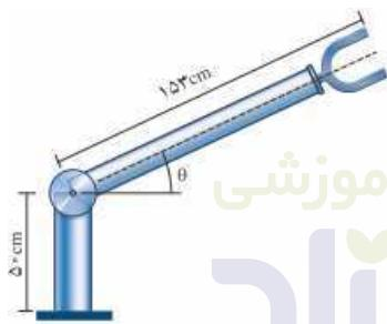
انواع روبات‌ها از توابع مثلثاتی استفاده می‌شود. در شکل روبرو یک روبات صنعتی را که در صنایع خودرو سازی کاربرد دارد، مشاهده می‌کنید. با توجه به مقادیر داده شده، ارتفاع نوک گیره‌ی روبات را از سطح زمین به کمک یک تابع مثلثاتی مدل سازی کنید.
