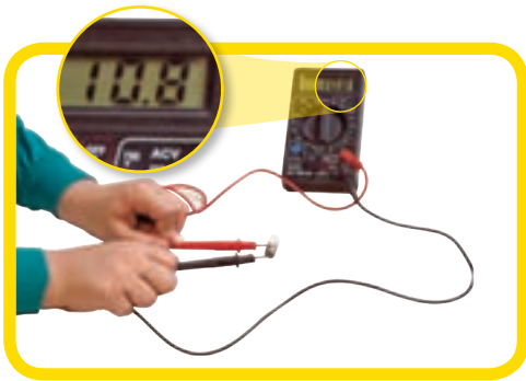
شکل ۸- اندازه‌گیری مقاومت لامپ خاموش با اهم سنج
