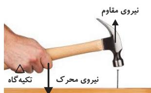
این اهرم، از نوع اهرم نوع سوم است که در آن نیروی مقاوم در یک سمت اهرم، تکیه‌گاه در سمت دیگر و نیروی محرك در حد فاصل بین این دو قرار می‌گیرد. حال هرچه طول بازوی مقاوم بیشتر شود مزیت مکانیکی اهرم کمتر ولی سرعت حرکت آن بیشتر خواهد شد. پس در چکش B، مزیت مکانیکی بیشتر است و در چکش A، گشتاور وارد بر میخ بیشتر است.
